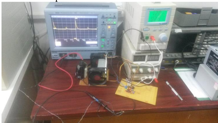
Figura III.4.4. Montajul pentru măsurarea semnalului de ieșire
