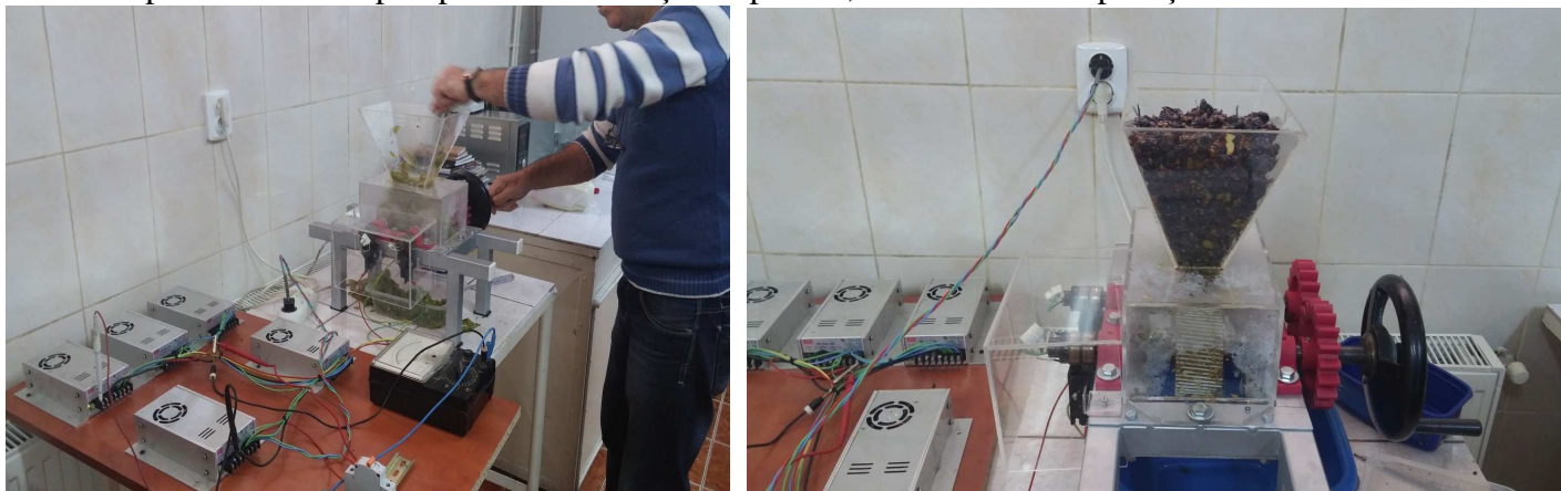
Figura II.2. Tratarea mustuiei/boștinei în câmp electric pulsatoriu
